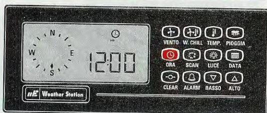
Fig.16 Per impostare l'ora premete il tasto dell'ORA e rilasciatelo. Apparirà il simbolo dell'orologio con la scritta AM o PM che significa ant-meridian o post-meridian corrispondenti al formato anglosassone.
