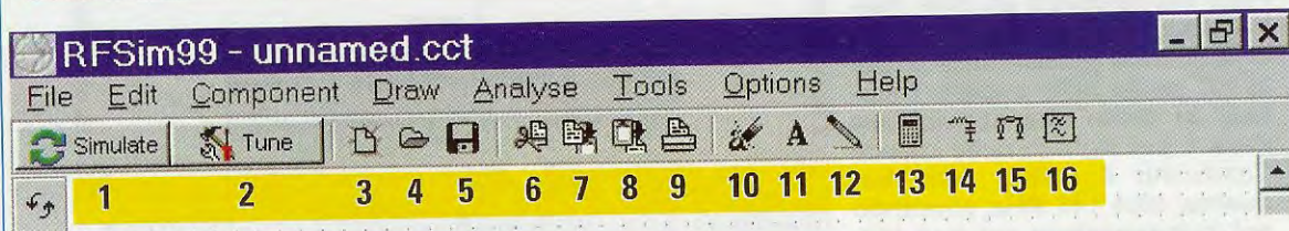
Fig.2 Dopo aver cliccato sull'icona RFSim99 di fig.1 il programma diventerà operativo e sul monitor vi apparirà questa finestra. Sotto la scritta "RFSim99 - unnamed.cct" sono presenti 8 diverse scritte corrispondenti ad altrettante cartelle. Premendo sulla tastiera del computer la lettera "sottolineata" in ciascuna scritta richiamerete il relativo file, ad esempio la lettera H per aprire il testo dell'Help oppure la lettera T per far apparire la funzione Tools. Nella riga sottostante sono presenti 16 icone associate ciascuna ad una funzione che in parte abbiamo descritto nella rivista precedente e che ora completeremo.
