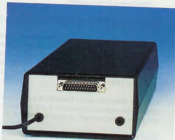
Fig.22 Dal pannello posteriore del mobile esce il connettore maschio a 25 poli per il collegamento con la porta parallela.
