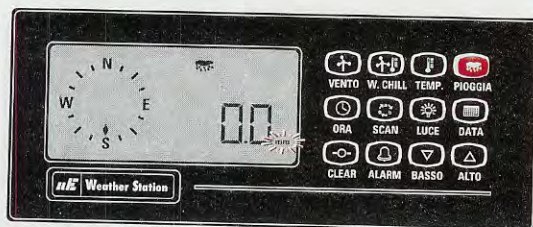
Fig.30 Ripetendo la stessa operazione, vedrete apparire la dicitura "0.0 mm", con la scritta mm lampeggiante. Questo significa che la lettura delle precipitazioni sarà in mm con un incremento pari a 0.1 mm.
