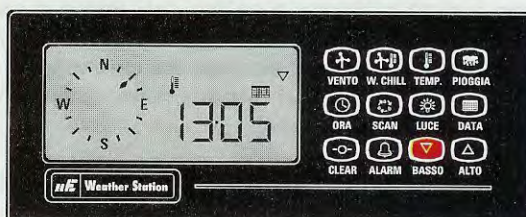
Fig.45 Quindi dovrete premere e rilasciare il tasto BASSO e vedrete apparire sul display la data corrente, il simbolo del calendario e un triangolo rivolto verso il basso, ad indicare il valore minimo di temperatura.
