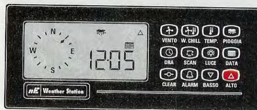
Fig.49 Se ora desiderate visualizzare le precipitazioni avvenute nella giornata di ieri, premete e rilasciate il tasto ALTO . Sul display compariranno il simbolo del calendario e la data di ieri.
