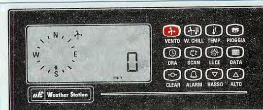
Fig.23 Premendo e rilasciando il tasto VENTO compare il simbolo relativo all'anemometro e la centralina presenta la prima volta la velocità del vento espressa nell'unità anglosassone delle miglia orarie (mph).
