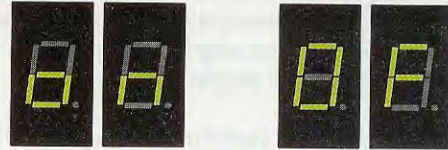
Fig.11 La prima volta che usate il timer, premete il pulsante Mode fino a quando non compare la scritta "on". Per disinserire l'allarme sonoro premete il pulsante - e sui display comparirà la scritta "OF".
