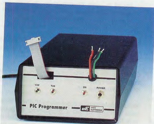
Fig.21 Dal pannello frontale escono i fili di alimentazione per il Bus e la piattina che collega il programmatore alla scheda Bus.
