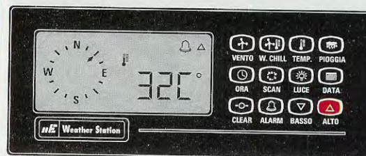
Fig.58 Per impostare un nuovo valore di allarme premete e mantenete premuto il tasto ALTO fin quando il display non terminerà di lampeggiare. Ora potrete modificare il valore agendo su ALTO o BASSO.
